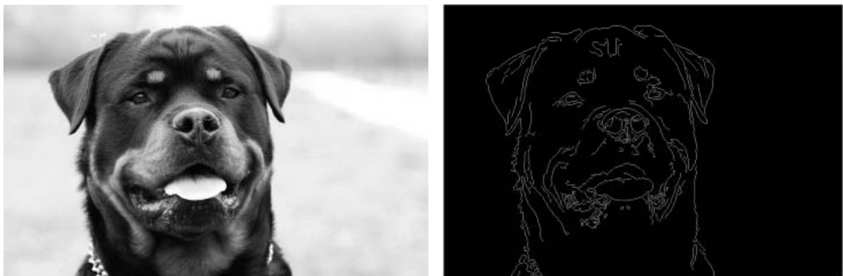
รูปที่ 2 ตัวอย่างการทำ edge detection โดยวิธี canny edge โดยใช้ Maximum Threshold = 0.2 ข้อมูลจำนวนมาก ถูกลดลง เพื่อให้จัดได้เฉพาะรูปร่างที่สำคัญของสุนัข Rottweiler
